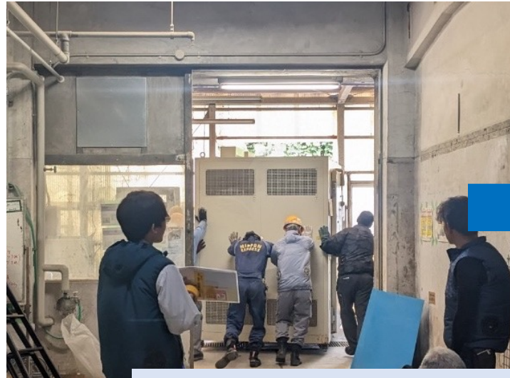
扉を外してチャンバーを新工場へ移設 Remove the door to move the chamber
